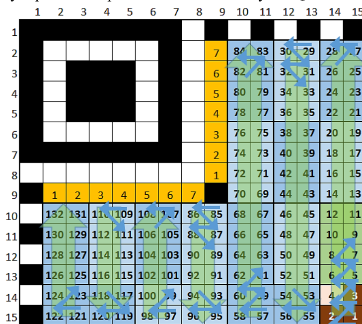
Рисунок 2 – Последовательность битов в блоках QR-кода
