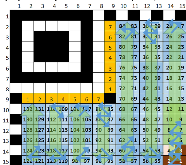
Рисунок 2 – Последовательность битов в блоках QR-кода
